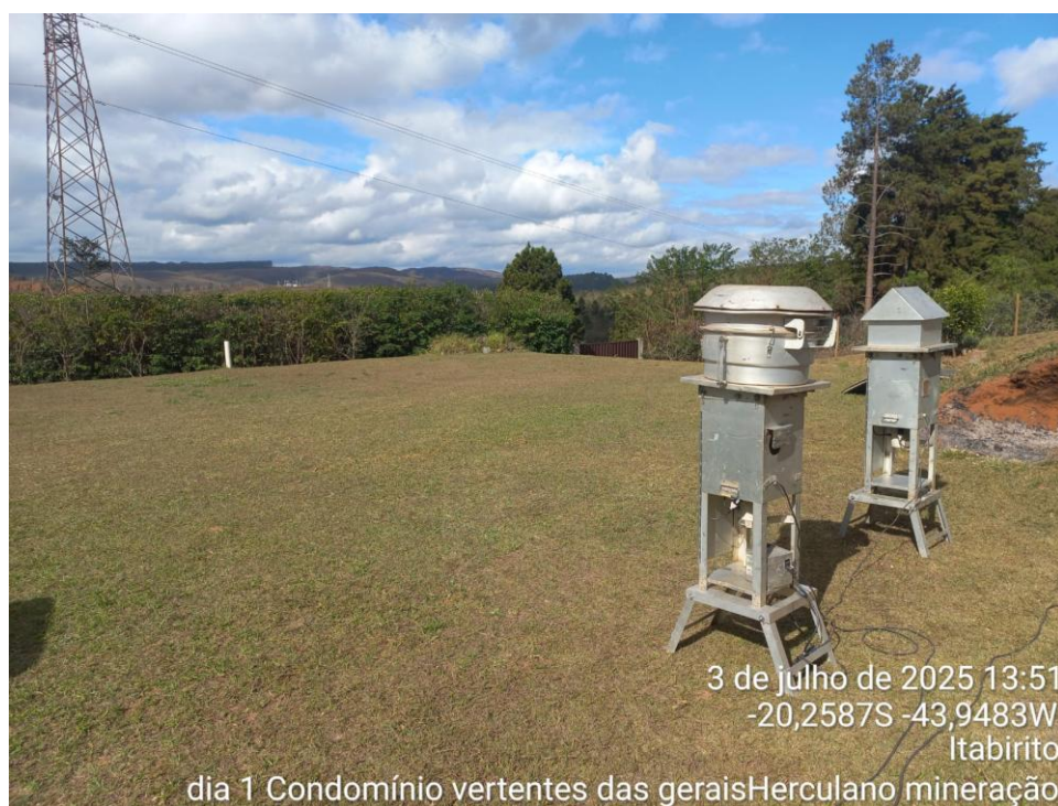
Figura 101 - Localização do ponto de monitoramento de qualidade de ar utilizado pela Herculano Mineração, no Condomínio Vertentes das Gerais, observando-se os dois equipamentos que medem, respectivamente, Partículas Totais em Suspensão (PTS) e Partículas Inaláveis ( PM_{10} ).
