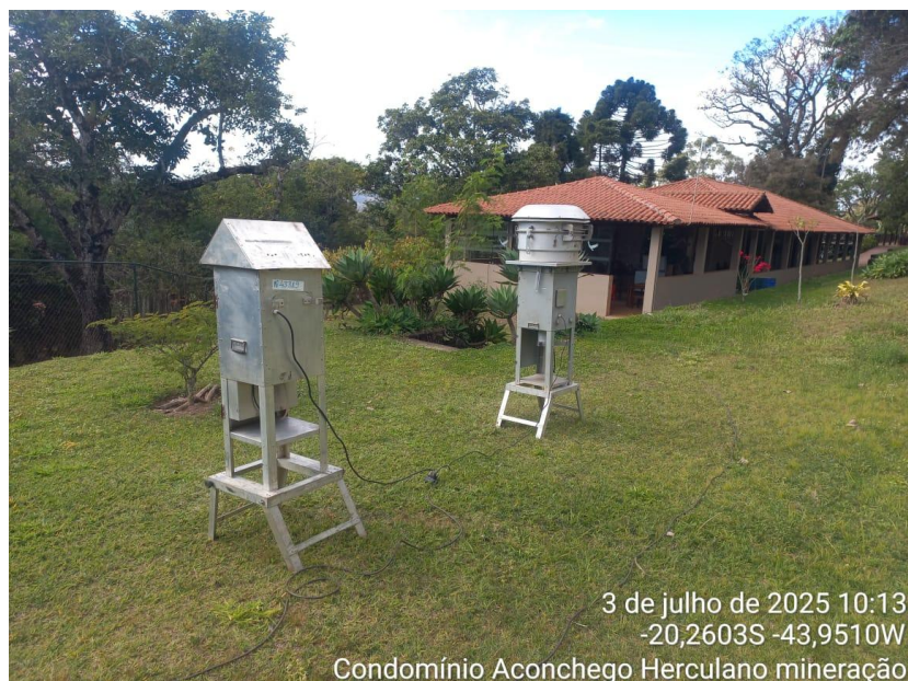
Figura 100 - Localização do ponto de monitoramento de qualidade de ar utilizado pela Herculano Mineração, no Condomínio Aconchego da Serra, observando-se os dois equipamentos que medem, respectivamente, Partículas Totais em Suspensão (PTS) e Partículas Inaláveis (PM 10 ).
